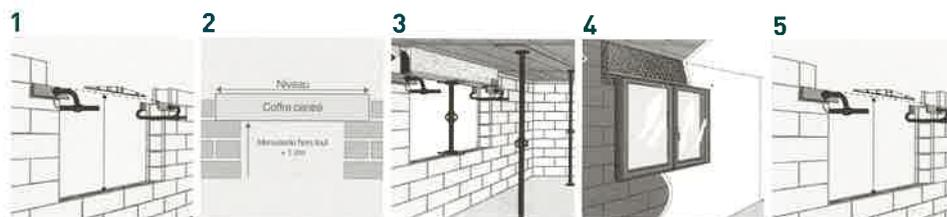
1. Préparation de l'assise du coffre CUZCO à l'aide de 4 planches tenues par serre-joint. Régler le niveau dans les deux sens.
